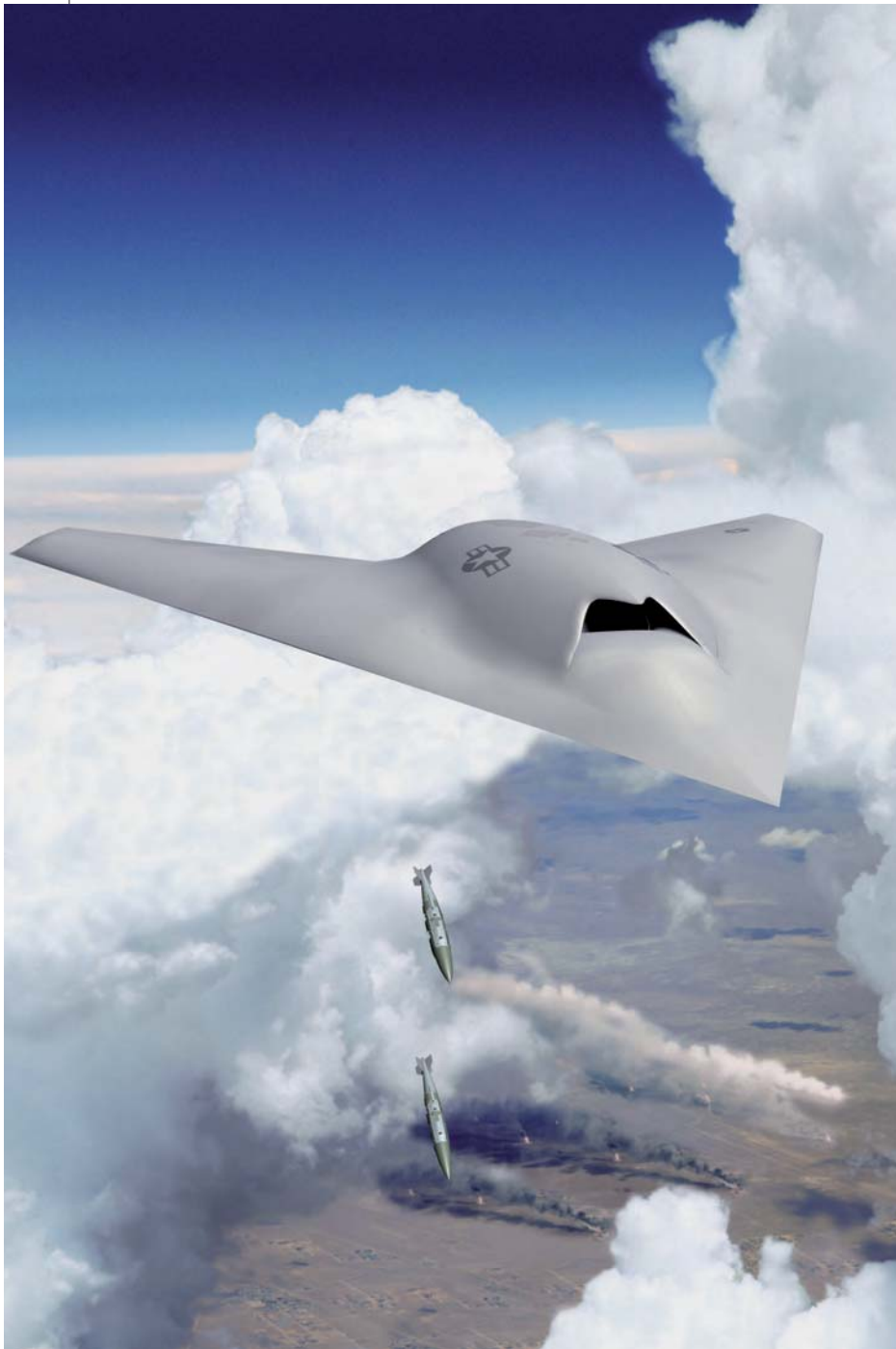
La configuración de ala volante será la elegida al ser la más óptima aerodinámicamente.
