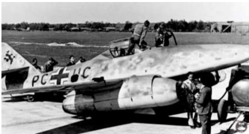
Detalle de la cabina abierta del Me-262. Al cerrarse "de lado" actuó de guillotina sobre el cuello del piloto.
