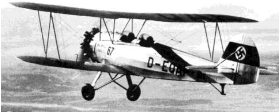
Heinkel 72, avión que todavía utilizaba una "reja" en la cola para frenar. La rueda de cola todavía no había llegado.
